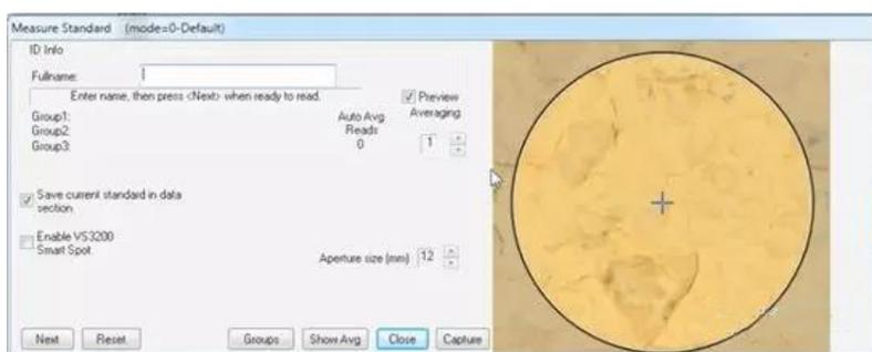
如果您直接进行测量，该设备会取所有可见的颜色的平均值，与标准分光光度仪测量颜色的方法相同。
