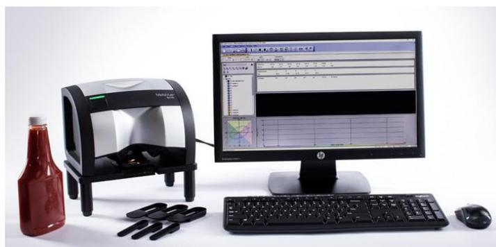
如果您测量的样本厚度不一，那么使用可调节支架就能让您控制样本和仪器之间的距离。支架边上有刻度，让您能够准确控制样本所需的高度。
