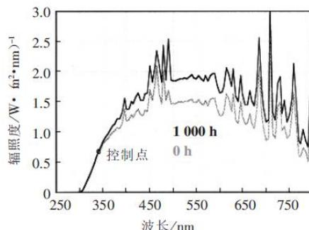
图 10 使用 1000h 后氙弧光灯的光谱输出
