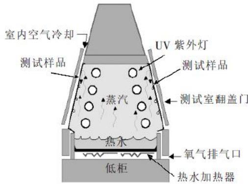
图5 QUV通过一个逼真的冷凝系统来模拟室外的潮湿侵蚀
