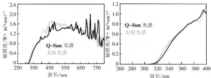
图7 配备有窗玻璃过滤器的Q-Sun光谱和透过玻璃的太阳光谱之间的比较
