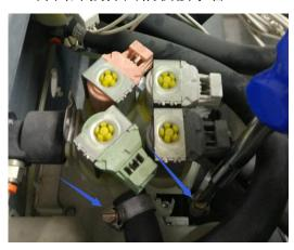
4.此时,进水阀可以旋转并取出如下图。更换新的进水阀把各接水管接上,螺丝上紧,把控制线接上,恢复机器拆卸前原貌,更换进水阀的操作便完成。
