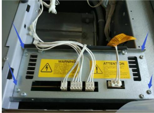
3.拆开机器后盖，从后测往上看看到变频器的底部有一铁盒。卸掉 2 个螺丝，铁盒往前拔可以拿下，然后拔下变频器的主电源线即可。然后拆卸如上图所示 4 个固定螺丝。
