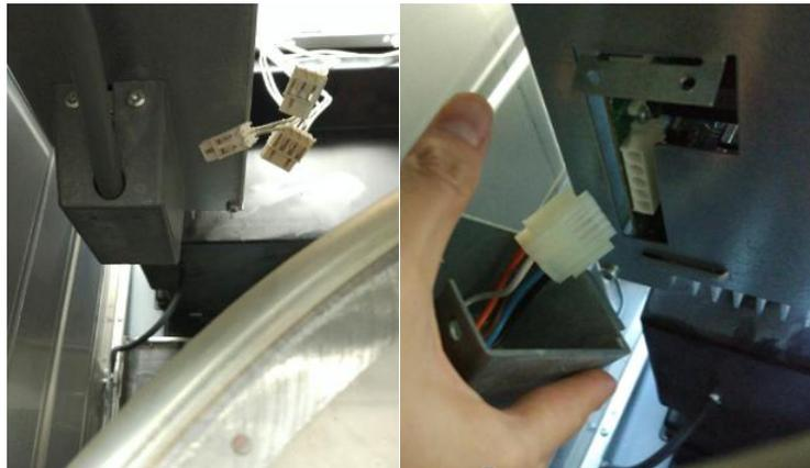
4.此时，变频器可以取出。更换新的变频器接好每个部位的接线，还原机器并对欧标缩水率洗衣机进行测试运行。变频器问题可解决。
